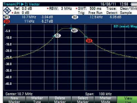
Bild 19: Einfügedämpfung des Quarzfilters
