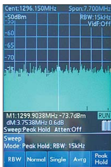
Bild 7: Störnebel am HDMI-Kabel A
