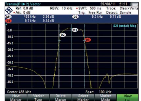
Bild 21: Einfügedämpfung des Keramikfilters
