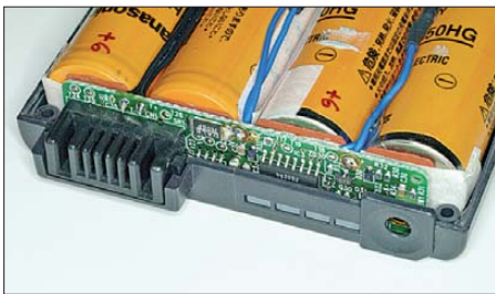
Bild 13: Innenleben eines Lilon-Akkus für Notebooks mit Temperatursensoren zwischen den Zellen sowie Überwachungselektronik
