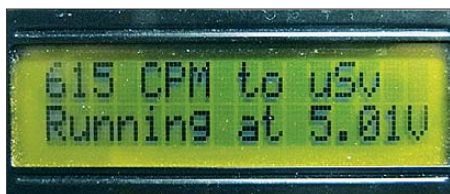
Bild 16: Betriebsspannungsanzeige kurz nach dem Einschalten
