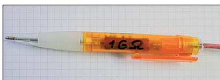
Bild 20: Mögliche Realisierung eines Hochspannungstastkopfs
