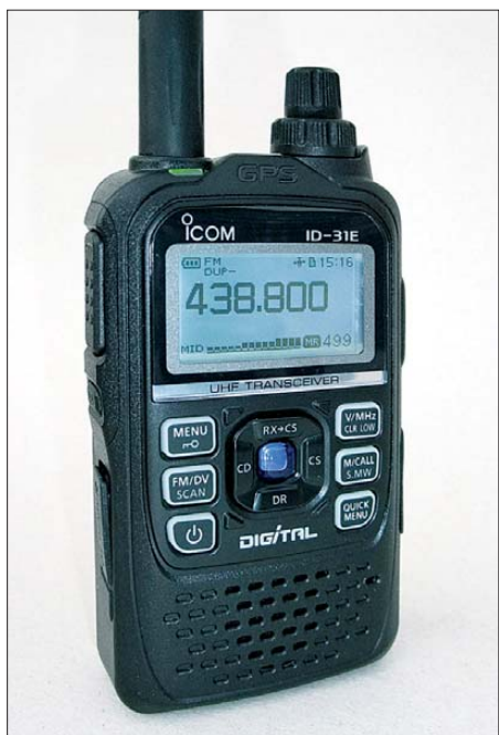
Bild 1: Automatisch bei Bedienung oder dauerhaft ist die Anzeige gleichmäßig weiß und sind die großen Tasten grün beleuchtbar. Das grafische Display blendet Meldungen und Menüs als Fenster ein.
