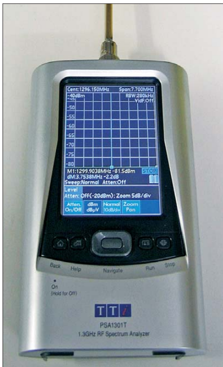
Bild 1: Messung mit dem Spektrumanalysator PSA1301T [2] und der 23-cm-Sperrtopf-antenne
