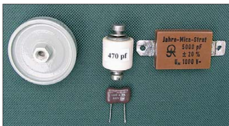
Bild 2: Beispiele für Kondensatoren, die in Röhrenendstufen eingesetzt werden können; oben links ein russischer 10-kV-Scheibenkondensator, in der Mitte ein sogeannter 6-kV-Doorknob („Türknope“), oben rechts ein 1-kV- und unten ein 500-V-Glimmerkondensator
