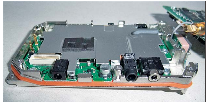
Bild 10: Der eigentliche Sende-/Empfangs- zug verschwindet unter einem großen Abschirmblech.
