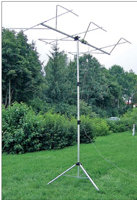
Bild 1: Triple-M-Beam für das 6-m-Band im Test; das USB-Kabel führt zu dem direkt an der Antennenbuchse angeschalteten Antennenanalysator.
