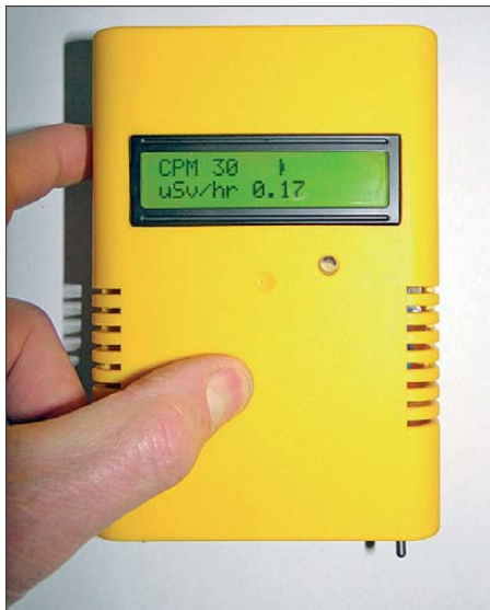
Bild 1: Fertig gebauter Geigerzähler im Gehäuse Fotos: DJ7BU
