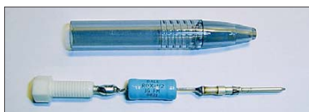
Bild 19: Einbau eines Hochspannungstastkopfs in ein Vorderteil eines Kugelschreibers
