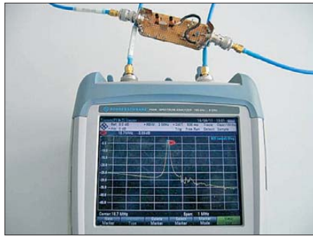
Bild 18: Messaufbau zur Bestimmung des Frequenzgangs des 10,7-MHz-Quarzfilters
