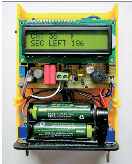
Bild 2: Geigerzähler mit Dosismessung, Frontplatte noch nicht aufgesetzt
